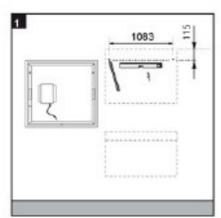
Pomocí vodováhy a tužky na stěnu vyznačte požadovanou výši, ve které zrcadlo bude umístěno. Jako referenční bod berte vrchní hranu zrcadla. Od tohoto bodu vyznačte směrem dolů vzdálenost 115 mm. V této vzdálenosti jsou otvory připravené v rámu zrcadla, jejich rozteč je závislá na velikosti zrcadla. Vyznačte na zdi místa pro otvory na hmoždinky podle nákresu.
