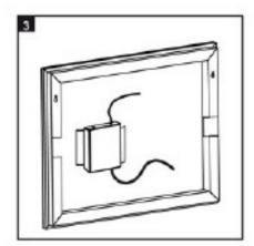
Před zavěšením připojte zrcadlo k přívodu elektřiny pomocí svorkovnice. Dbejte na správné zapojení podle barevného značení vodičů.
